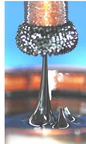
Ferrofluid unter der Wirkung des Magnetfelds eines einfachen Elektromagneten.
